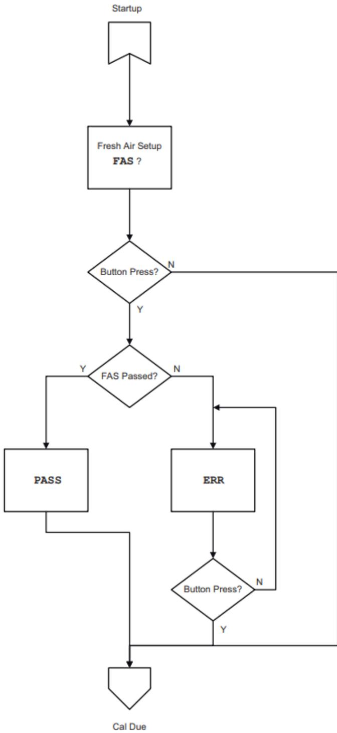
Figure 5 FAS (appareils sans technologie XCell Pulse)
