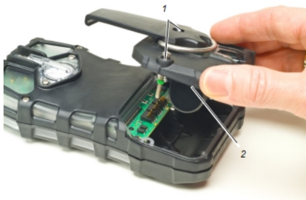
Figure 13 Remplacement de la batterie
