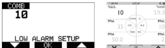
Figura 10 Configurazione dell'allarme dei sensori
