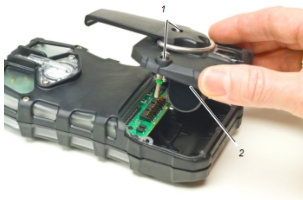
図 13 バッテリー交換
