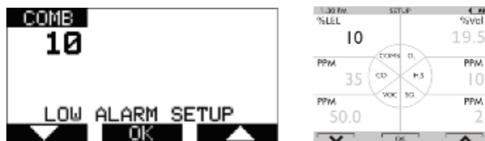
Slika 10 Postavljanje alarma senzora
