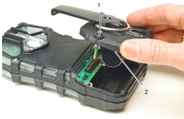
Figura 13 Substituição da bateria
