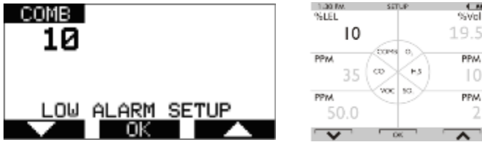
Gambar 10 Pengaturan Alarm Sensor
