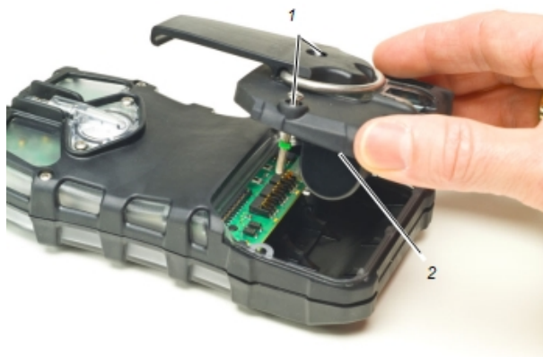
Figura 13 Sostituzione della batteria
