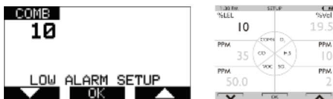
рисунок 10 Настройка сигнализации от датчиков
