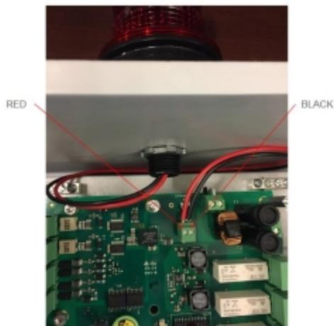
*Figure 18 Strobe wiring*
