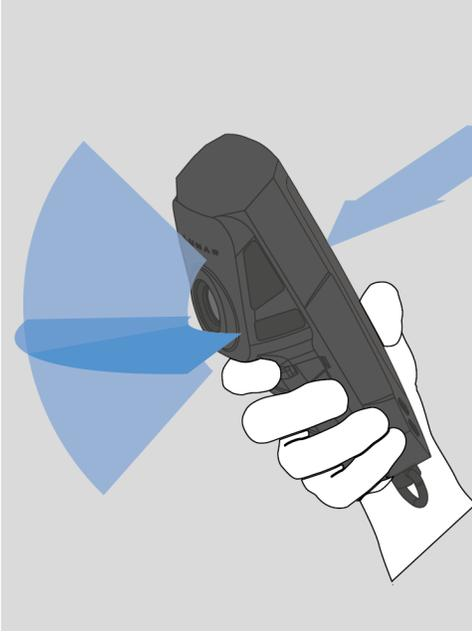
LUNAR 设备的定向搜索天线与[热成像仪 \(TIC\)](#)的中轴线位于一条直线上。
