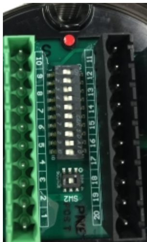
Figure 18 Emplacement du commutateur DIP
