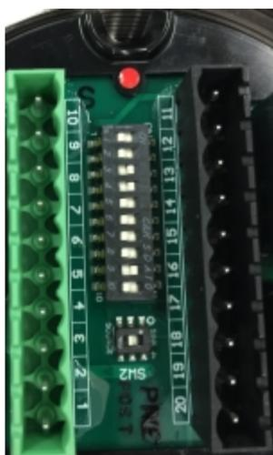
Figura 18 Posizione del DIP switch
