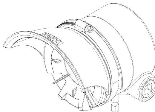
Figura 21 FL500 con protezione antipioggia collegata
